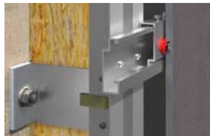
Homlokzat keresztmetszet Tergo+ dübellel
